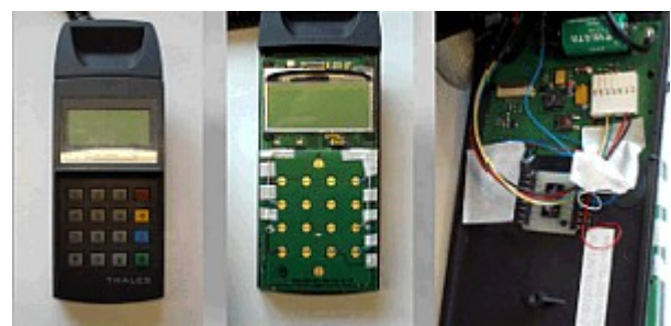
POS-Skimming: Manipuliertes Eingabegerät (POS-Terminal) aus dem Einzelhandel. Mit einer eingelegten Folie (Bild Mitte) werden die Tastatureingaben abgegriffen und zusammen mit den Kartendaten gespeichert (Bild rechts). Quelle: BKA 2009.
